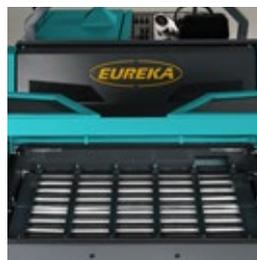
Filtro antistatico, lavabile, con sistema di shakeraggio automatico per la pulizia. Per un filtraggio elevato e costante nel tempo.
