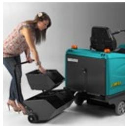
Posizionato sul retro della macchina il contenitore dei rifiuti offre una capienza effettiva di raccolta di 63 litri (o 83 Kg). È in acciaio, montato su ruote e dotato di un comodo maniglione per il trasporto durante le operazioni di scarico. I cassetti riduttori opzionali rendono lo svuotamento ancora più semplice.
