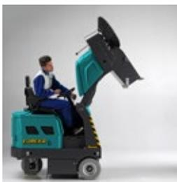
Il cassonetto rifiuti è posizionato frontalmente e può essere sollevato idraulicamente fino a 1.565 mm dal suolo. Il cassonetto è flottante e si regola automaticamente, permettendo una raccolta molto semplice dei detriti più voluminosi.
