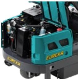
Tutti gli organi meccanici interni sono facilmente accessibili per le operazioni di manutenzione, poiché i pannelli posteriori, laterali e superiori si possono aprire completamente. Le batterie (Versione EB EVOLUTION) possono essere sostituite facilmente e rapidamente.
